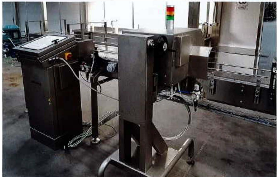
Sistema di controllo di livello ControlLevel XRays. / Fill level control system ControlLevel XRays (Parmacontrols).
